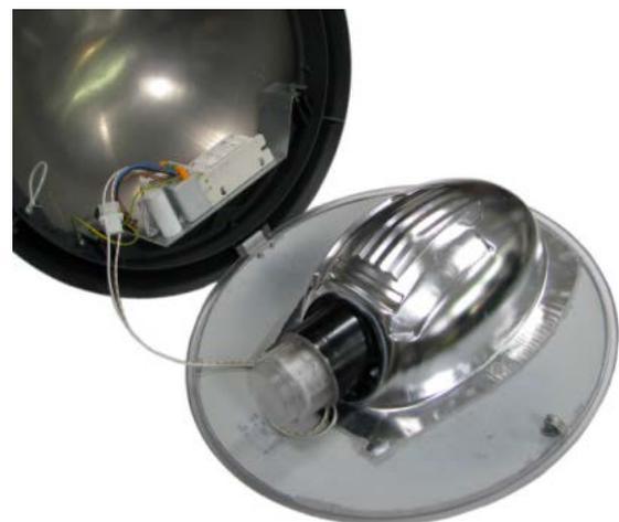
Fig. 2 Luminaria SOCELEC IMAGE con grupo óptico y equipo de alimentación originales
