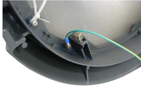
Fig. 10 Conexión del cable de tierra
