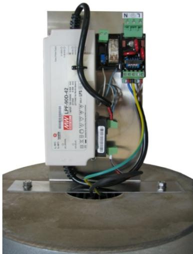
Fig. 5 Montaje del Módulo de alimentación ILUZ252.P
