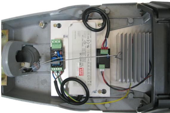
Fig. 7 Conexión del Módulo LED de retrofit
