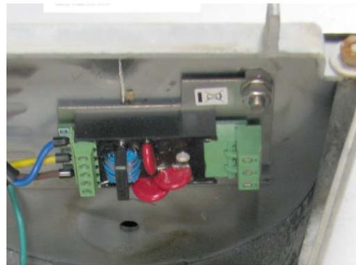
Fig. 6 Detalle de montaje del Módulo de protección INELCOM ILUZ238.A al tabique central
