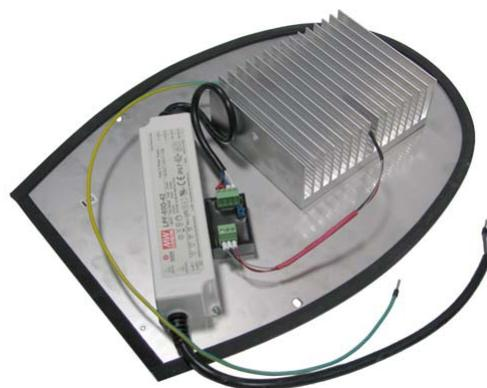
Fig. 2 Módulo LED de retrofit INELCOM para luminaria SOCELEC DM1 ILUZ3B6.A
