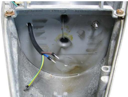
Fig. 5 Paso de cables al compartimento del equipo de alimentación
