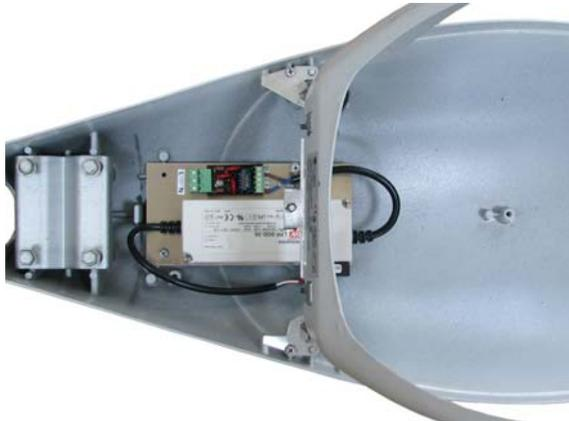
Fig. 5 Detalle de montaje del Módulo de alimentación en luminaria G.E. M-250A.
