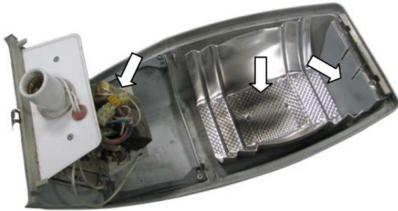
Fig. 3 Elementos a retirar de la luminaria
