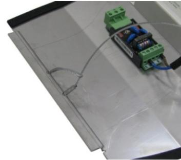
Fig. 4 Detalle de montaje del kit cable de acero al Módulo LED retrofit
